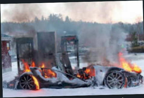
Gjerstad (NOR), 1. 1. 2016: An einem Supercharger brennt ein Model S beim Ladevorgang ab. Ursache ist laut Tesla ein Kurzschluss im Auto
