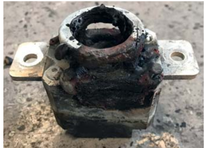
Bild 4: Thermofuse-Prototyp nach erfolgtem Partikelbeschuss: Die Abschaltfunktion hat er vollständig erfüllt.
