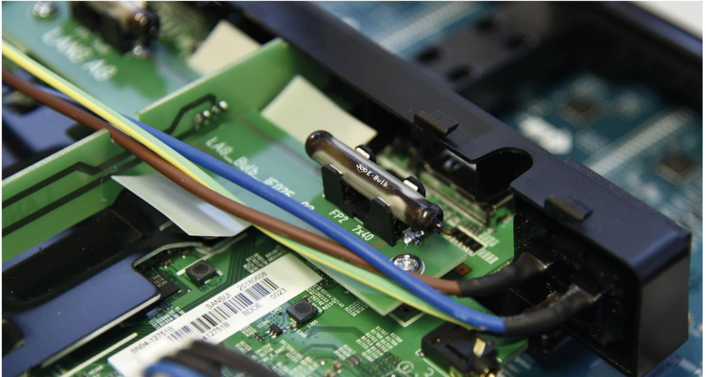
Wenn es innerhalb des elektrischen Gerätes anfängt zu brennen, detektiert die E-Bulb das Feuer und löscht es automatisch. Zusätzlich wird der Strom dauerhaft unterbrochen, um einer Wiederentzündung vorzubeugen. Dadurch werden hohe Brandfolgeschäden verhindert und das Risiko von Betriebsunterbrechungen reduziert. Basierend auf der milliardenfach bewährten Sprinklerglastechnologie, wurde die E-Bulb in Deutschland entwickelt. 100% Made in Germany.
